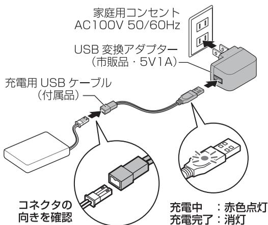
充電が完了したら充電用 USB ケーブルからバッテリーを取りはずし、バッテリーを元通り本体に接続し (コネクタ向きに注意)、バッテリーカバーをしっかりと閉じてください。
