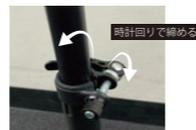
4. サドルの底にあるバーを持ち上げ、サドルを固定します。
